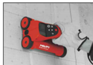
電磁誘導式鉄筋探査機
